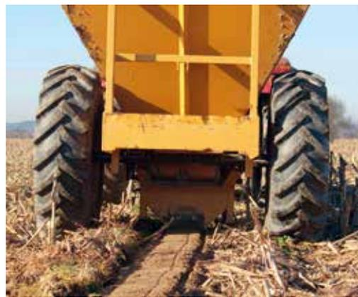
Com a introdução deste reboque que gentilmente nos foi cedido pela **IRRICAMPO**, poupamos a operação de abertura da vala e passamos a aplicar diretamente com este reboque a mistura de areia e seixo nos rodados profundos. Houve uma poupança de tempo em máquinas e na quantidade dos materiais utilizados e os resultados foram excelentes.
